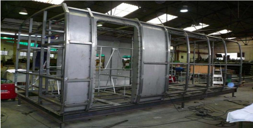
Figura 2.7. Estructura de un coche de ferrocarril.
