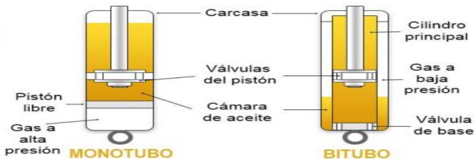
Figura 2.14. Tipos de amortiguadores hidráulicos.
