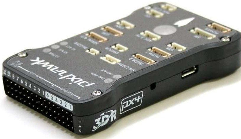
Ilustración 15. Pixhawk versión PX4 [28]
