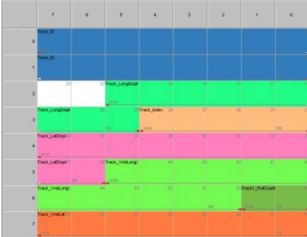
Ilustración 29. Estructura del mensaje 0x60C [SRR 208 Software Vers.:1.0.3.0]
