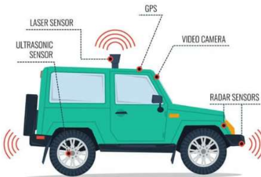
Ilustración 4. Hardware en un vehículo autónomo. Por programarfacil.com [6]
