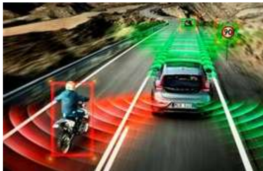
Ilustración 7. Posible ubicación de radares para la detección de obstáculos. [7]
