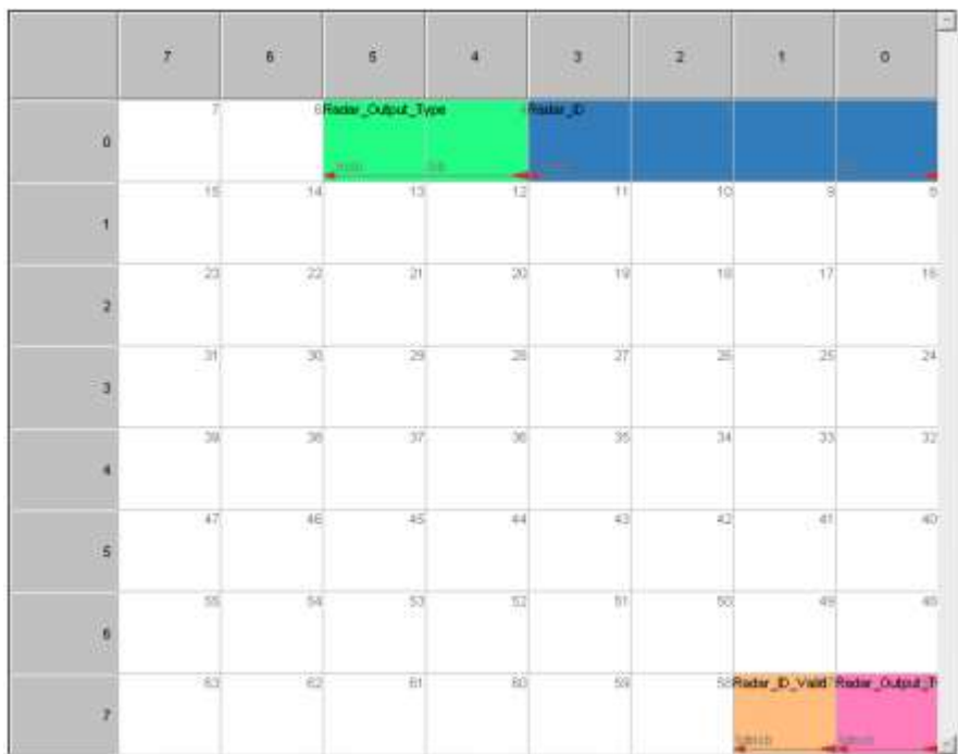
Ilustración 49. Estructura del mensaje de configuración (0x200) [SRR 208 Software Vers.:1.0.3.0]
