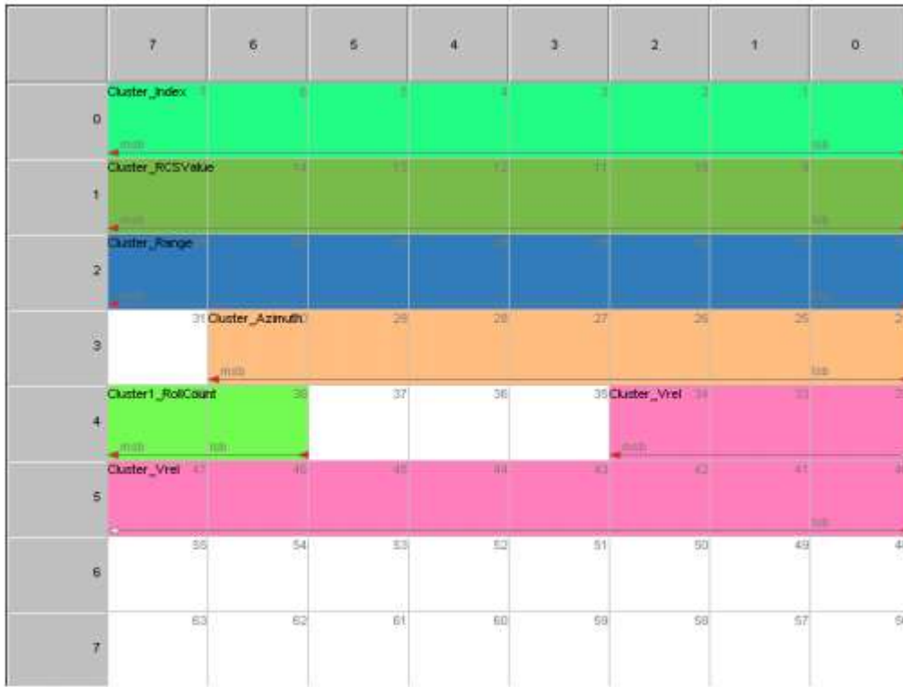
Ilustración 42. Estructura del mensaje 0x70C [SRR 208 Software Vers.:1.0.3.0]
