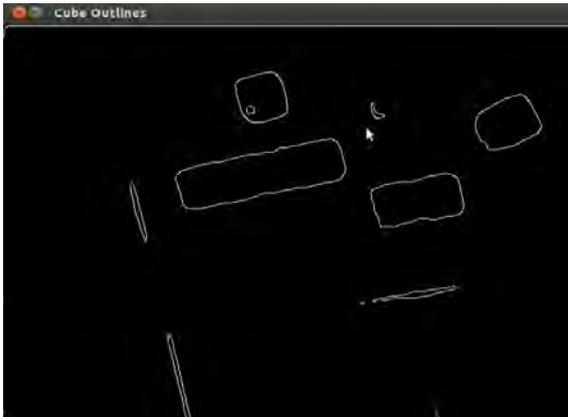
Figura 2.6: Aplicación de un filtro Canny a la imagen [32].
