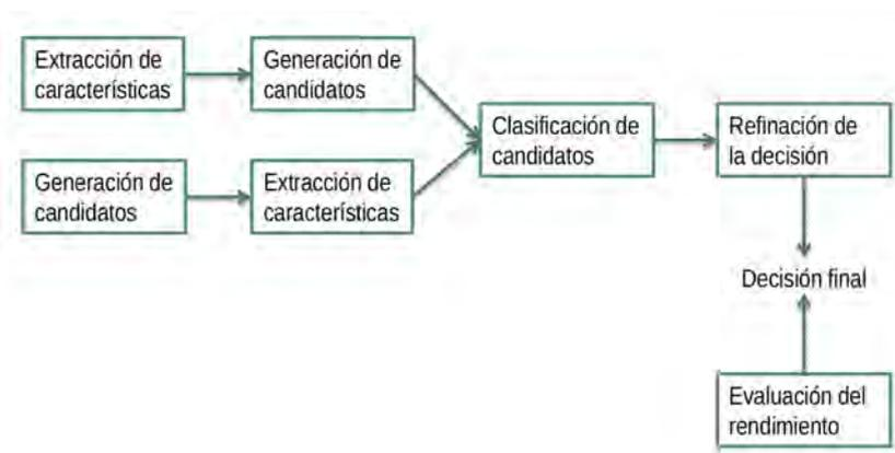
Figura 3.1: Proceso básico de detección [34].
