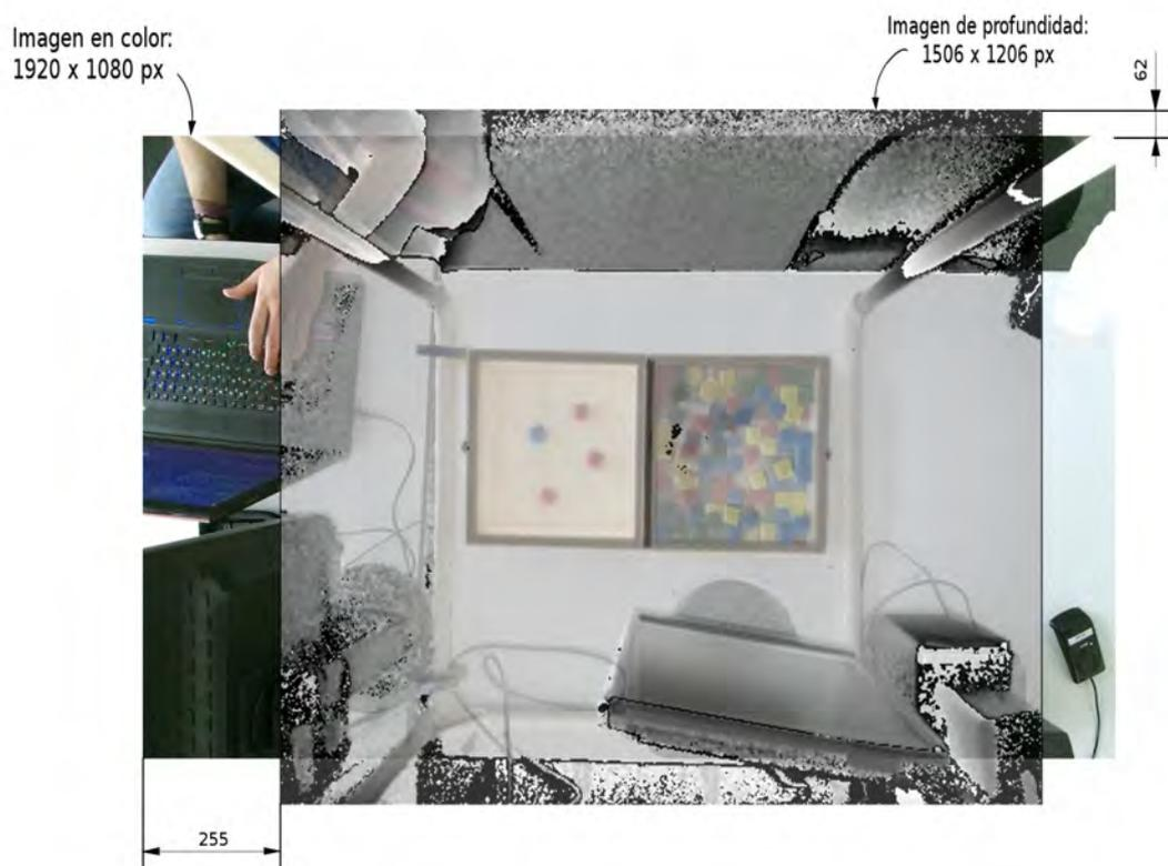
Figura A.16: Agrandamiento y superposición de las dos imágenes.
