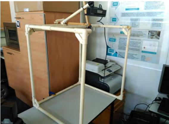
Figura 4.3: Bastidor usado para sujetar la cámara sobre el paciente.
