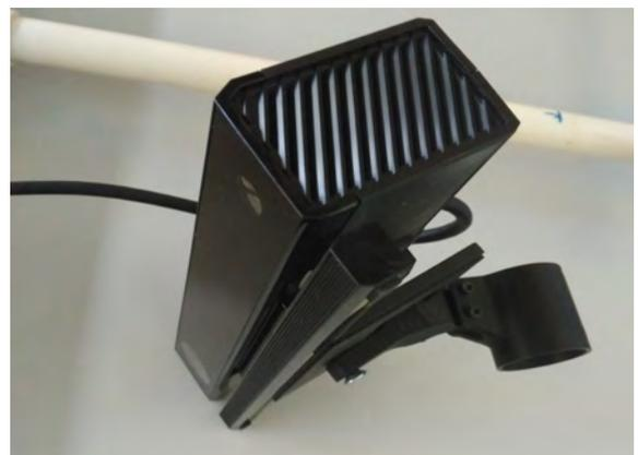
Figura 4.4: Detalle del acople de la cámara al bastidor.
