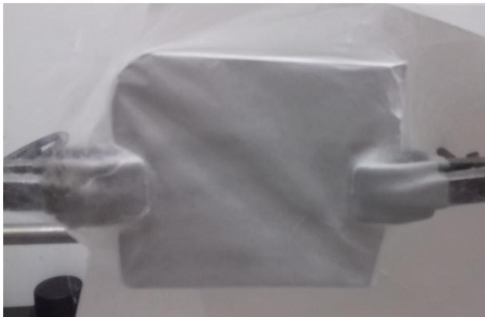
**Figura 24.** Film de PEO obtenido mediante SBS sobre un colector plano recubierto de papel de aluminio.
