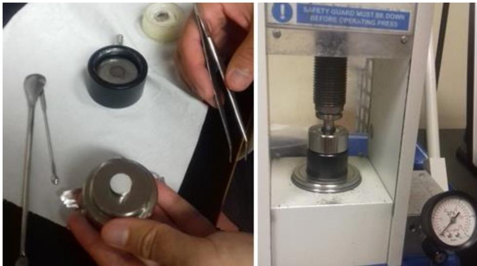
**Figura 20.** Fabricación de pastillas de bromuro potásico. Izquierda: molde. Derecha: prensa.
