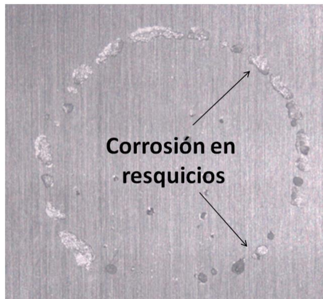
Figura 1.6. Imagen de una probeta donde se aprecia corrosión en resquicios después del ensayo por curvas de polarización.
