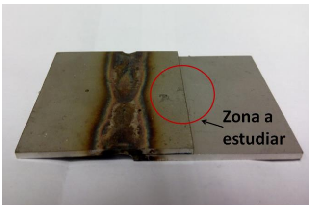
Figura 1.9. Ejemplos de probetas con superficies irregulares. Figure 1.1. Examples of samples with irregular surfaces.
