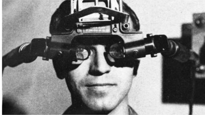
Ilustración 3 HMD (*Head-mounted Display*)
