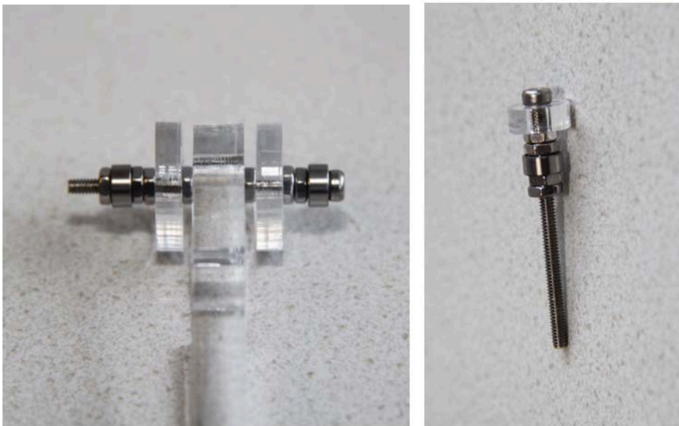
Ilustración 18 - Izq: Foto detallada del montaje final de un brazo del dispositivo. Der: Foto que muestra la disposición de cada eje acoplado a la base del dispositivo en el cual apoyan las caras laterales.
