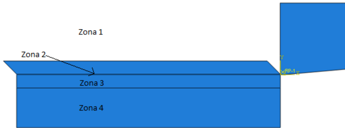
Figura 3-2. Zonas de mallado para la pieza a mecanizar
