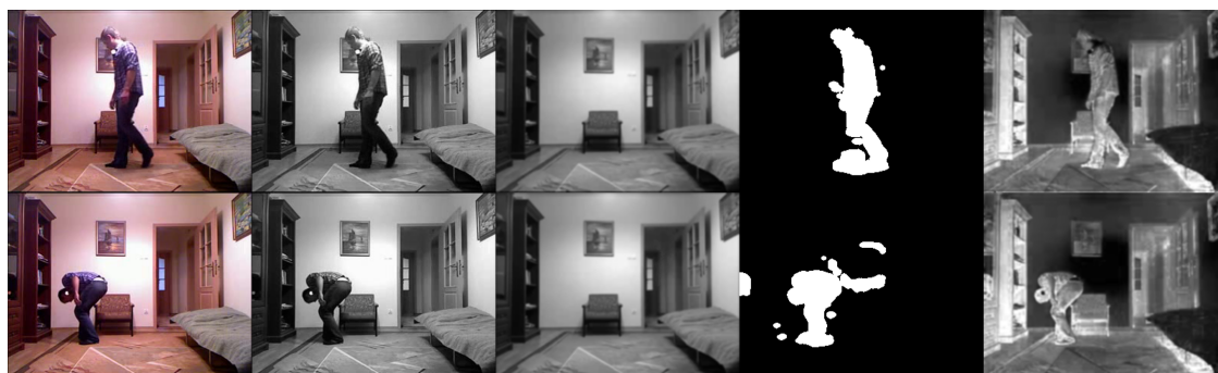
Figura 5.11: Influencia de la saturación en la máscara de movimiento
