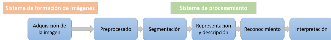
Figura 2.5: Etapas en una aplicación de visión artificial
