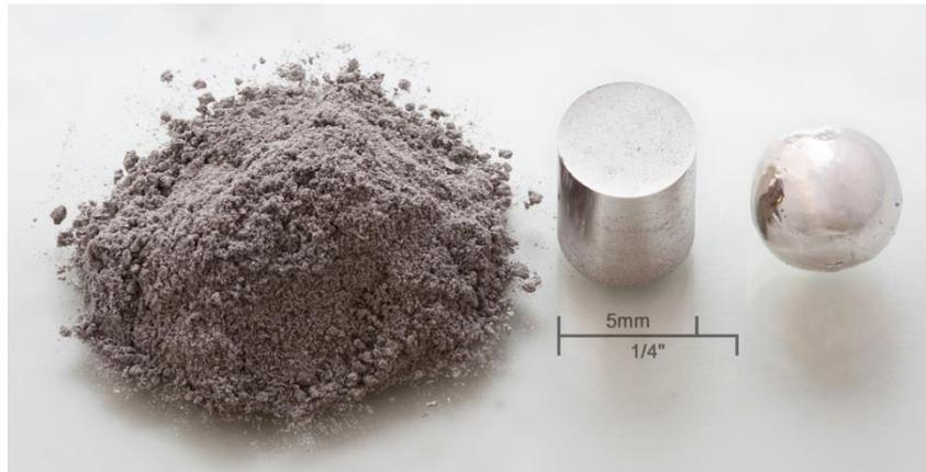
**Figura 2.2. Polvo aleación Cr-Co. Empleado para la fabricación aditiva de prótesis dentales. [22]**
