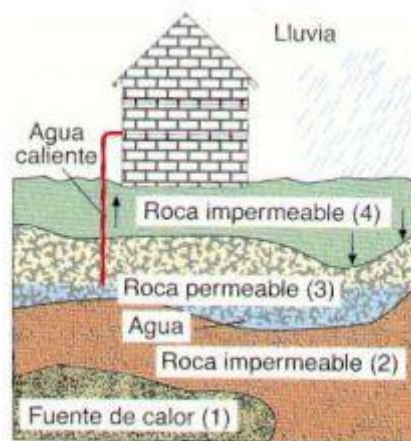
Figura 9. Sistema hidrotérmico [ https://iesvillalbahervastecnologia.files.wordpress.com/2011/11/energia-geotermica.pdf ]
