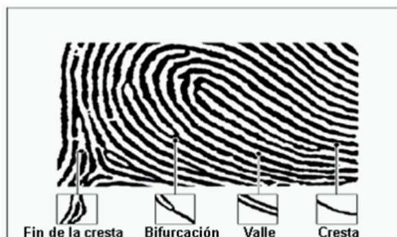
Ilustración 7 – Tipos de minucias en una huella dactilar [12]
