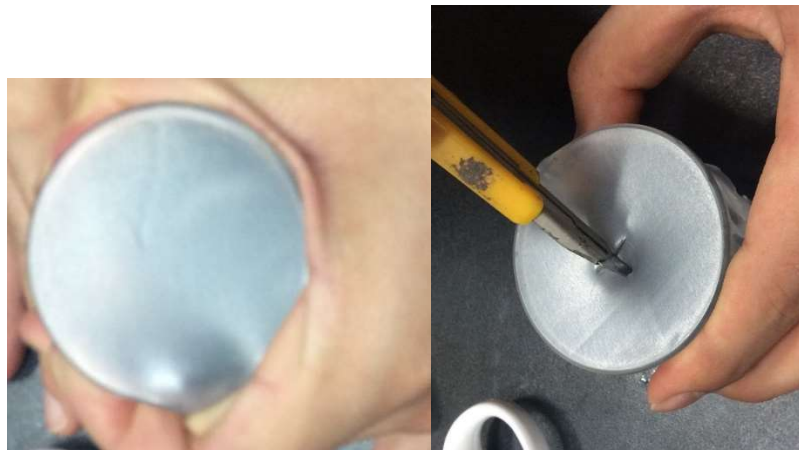
Figura 76: Imagen del vaso de precipitado sellado con el Parafilm (izqda.) e imagen que muestra la pequeña incisión realizada en el parafilm para evitar la concentración durante el mezclado magnético (dcha.).
