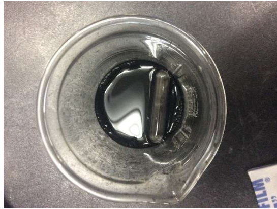
Figura 75: Imagen que muestra la capa del catalizador en estado líquido junto con la barra magnética.
