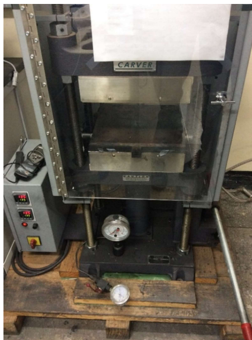
Figura 82: Prensa manual modelo Monarch, rango de prensado (1-15 toneladas) rango de temperatura (hasta 345°C).
