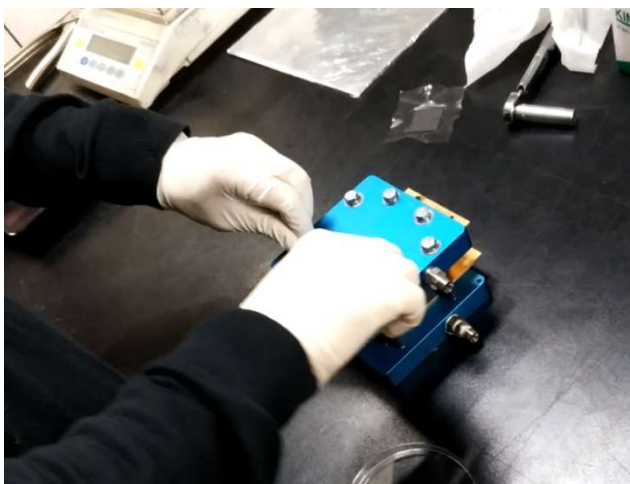
Figura 104: Apriete manual de las tuercas y posterior inspección visual.
