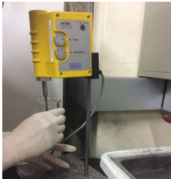
Figura 73: Mezclador ultrasónico, se realizan mezclados puntuales a lo largo del perímetro, se debe evitar tocar el fondo del vaso (puede suponer la rotura de este)
