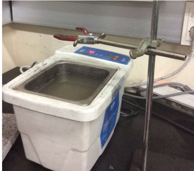
Figura 72: “micro wave mixer” herramienta de mezclado, se sumerge el vaso de precipitado (3/4) y las olas que golpean el vaso mezclan la disolución.
