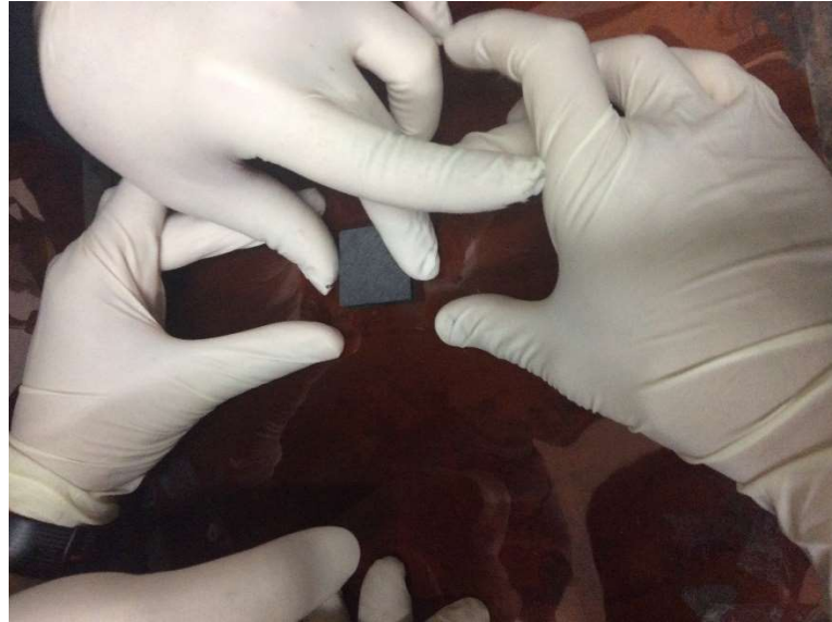
Figura 85: Colocación del ánodo sobre la membrana.
