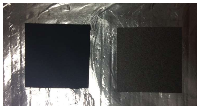
Figura 15: Imagen de las capas de difusoras de gases utilizadas en la fabricación de la MEA, cátodo (izqda.) y ánodo (dcha.).
