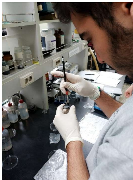
Figura 81: La imagen muestra el proceso de impregnación de la GDL utilizando el método “brushing”.
