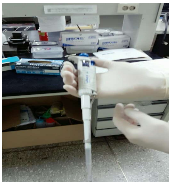
Figura 71: Pipeta de precisión utilizada para extraer la cantidad de Nafión exacta.
