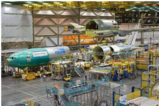
Figura 1.2. Diferentes partes de una aeronave en su proceso de montaje (Boeing, 2000).
