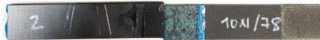
Figura 3.20. Probeta ensayada a cortadura para la obtención del módulo de cortadura del adhesivo.
