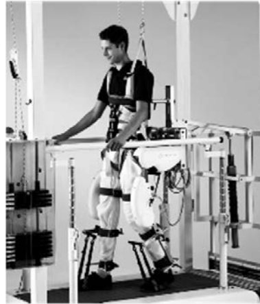
FIGURA 2.35: Entrenador de marcha Lokomat
