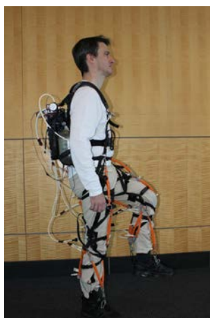
FIGURA 2.30: ExoSuit con un peso total de 9.121 kg
