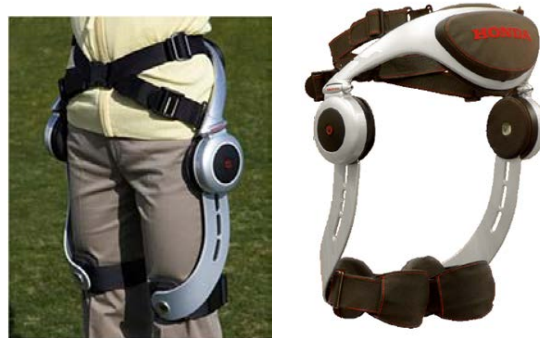
FIGURA 2.27: Sistema Stride Management Assist de Honda
