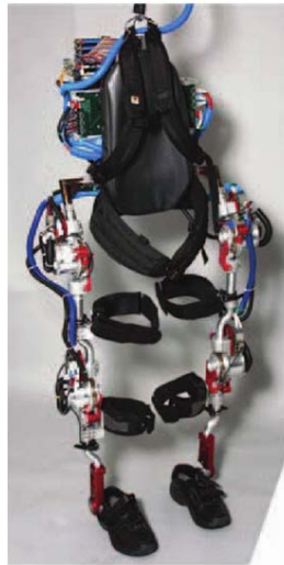
FIGURA 2.26: Exoesqueleto Mina de IHCM con cuatro grados de libertad actuados, que permite andar a pacientes con paraplejia a una velocidad de 0.2 m/s
