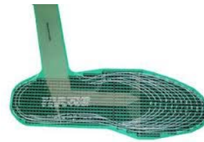
(b) tipo plantilla de F-Scan mobile
