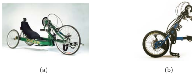
FIGURA 2.3: Sistema de tipo triciclo: (a) independiente (b) con opción de acoplamiento a la silla de ruedas convencional
