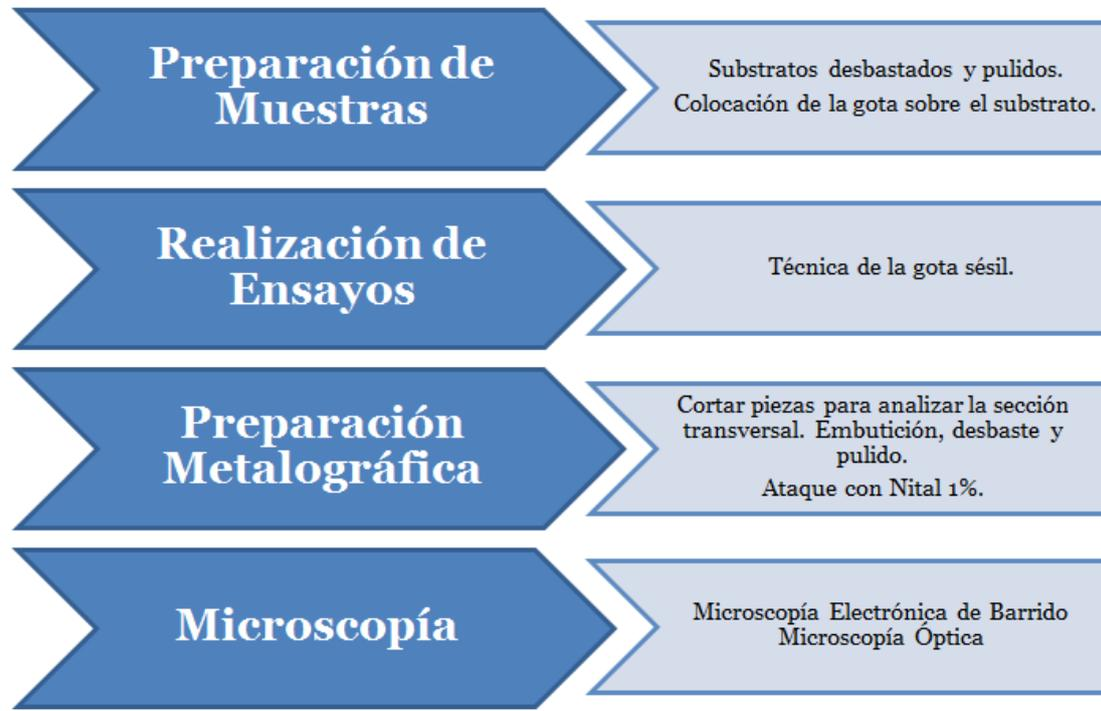
**Ilustración 14:** Esquema del procedimiento experimental seguido en los ensayos de mojado.
