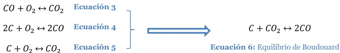
A temperaturas inferiores a la del equilibrio de Boudouard, el C se oxida formando CO<sub>2</sub> (Ecuación 3), mientras que a temperaturas superiores se oxida para formar CO (Ecuación 4) y la Ecuación 5 ocurre en sentido inverso. La temperatura de ese punto de equilibrio está determinada por el punto de corte entre la reacción de oxidación del metal y la reacción carbotérmica indirecta (Ecuación 2).
