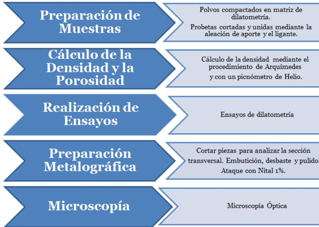
**Ilustración 19:** Esquema del procedimiento experimental seguido en los ensayos de dilatometría.
