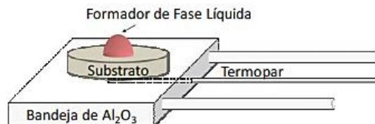
**Ilustración 16:** Detalle de la colocación de la muestra en la bandeja de alúmina en el horno de ensayo de mojado. El termopar se encuentra en el orificio central [6].
