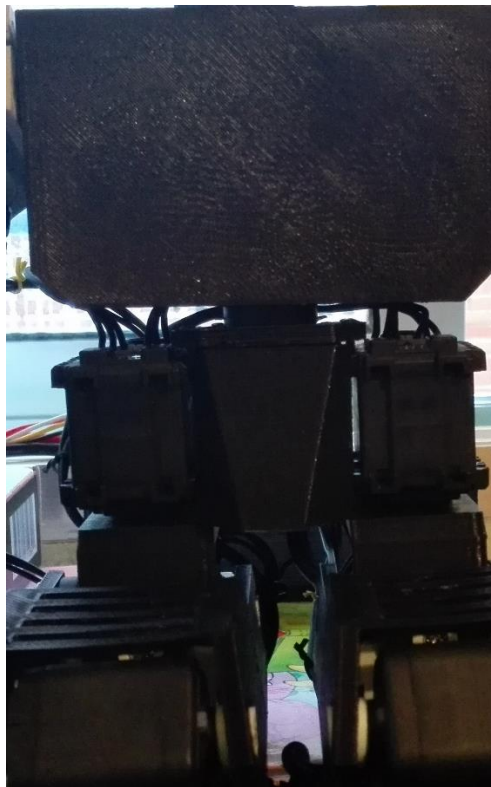
Figura 12.21: Unión de la pieza Body con el servo de la cintura CON alza
