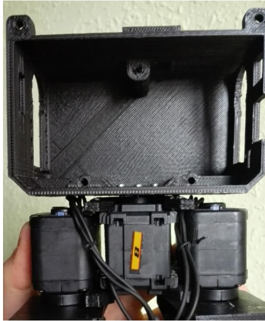
Figura 12.20: Unión de la pieza Body con el servo de la cintura SIN alza
