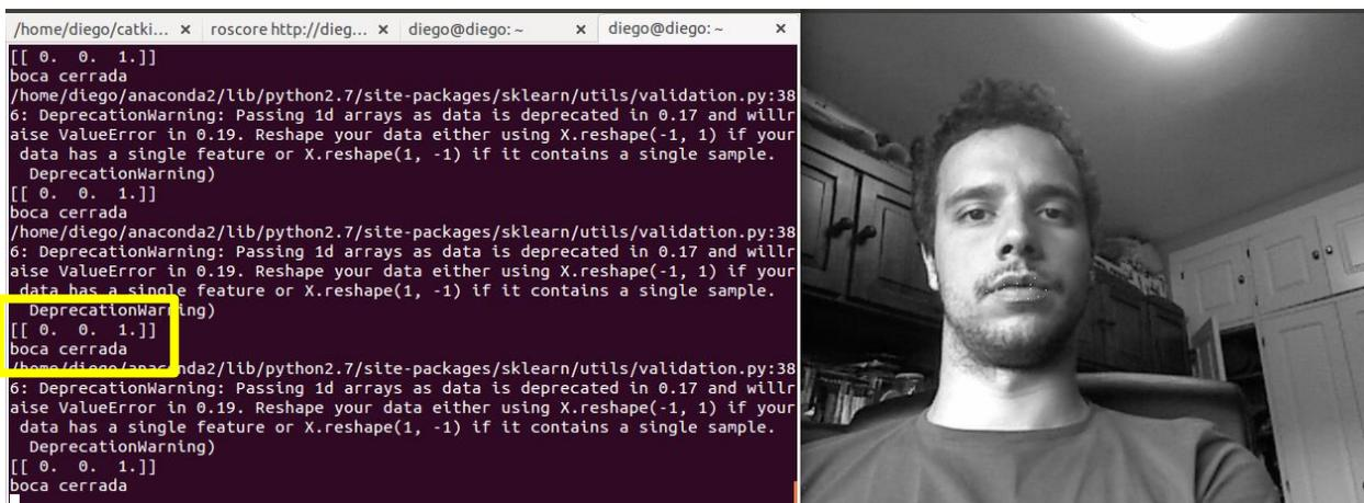
Figura 5.7: Respuesta del sistema al detectar la boca cerrada
