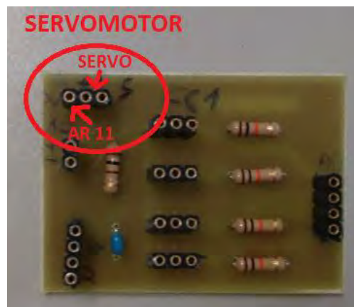
Figura 56. Distribución del servomotor en la PCB
