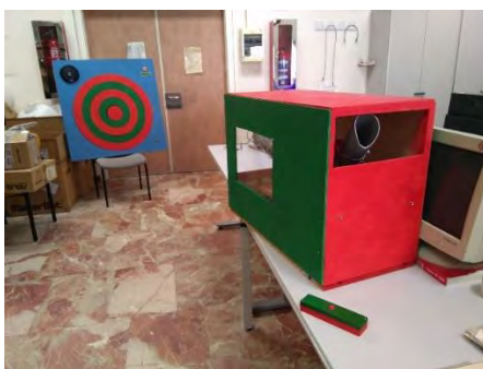
Figura 99. Prueba de comunicación entre diana y lanzabolas
