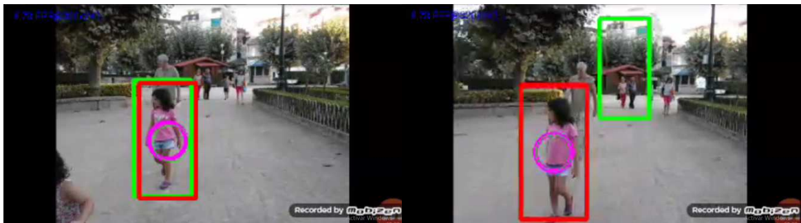
Figura 17. Izquierda: Detección y seguimiento de un peatón. Derecha: seguimiento del peatón en ausencia de detección
