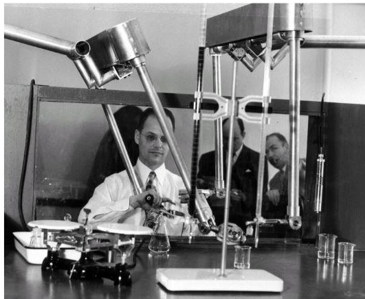
Ilustración 11 - Goertz manejando el teleoperador M1
