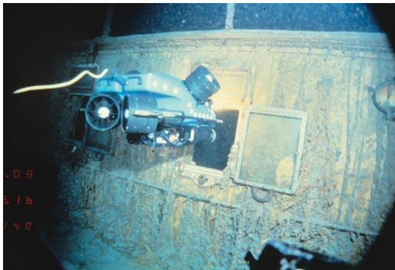
Ilustración 15 - Jason Jr explorando los restos del Titanic en 1986
