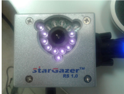
Figura 5.2: Mal funcionamiento de los Leds del Stargazer.
