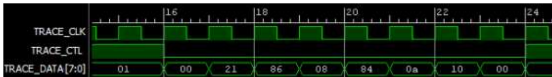
Figura 5-3 Captura de las señales de traza activa
