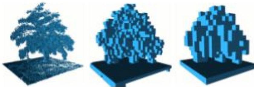
Figura 23. Octomap con diferentes resoluciones de un árbol.
