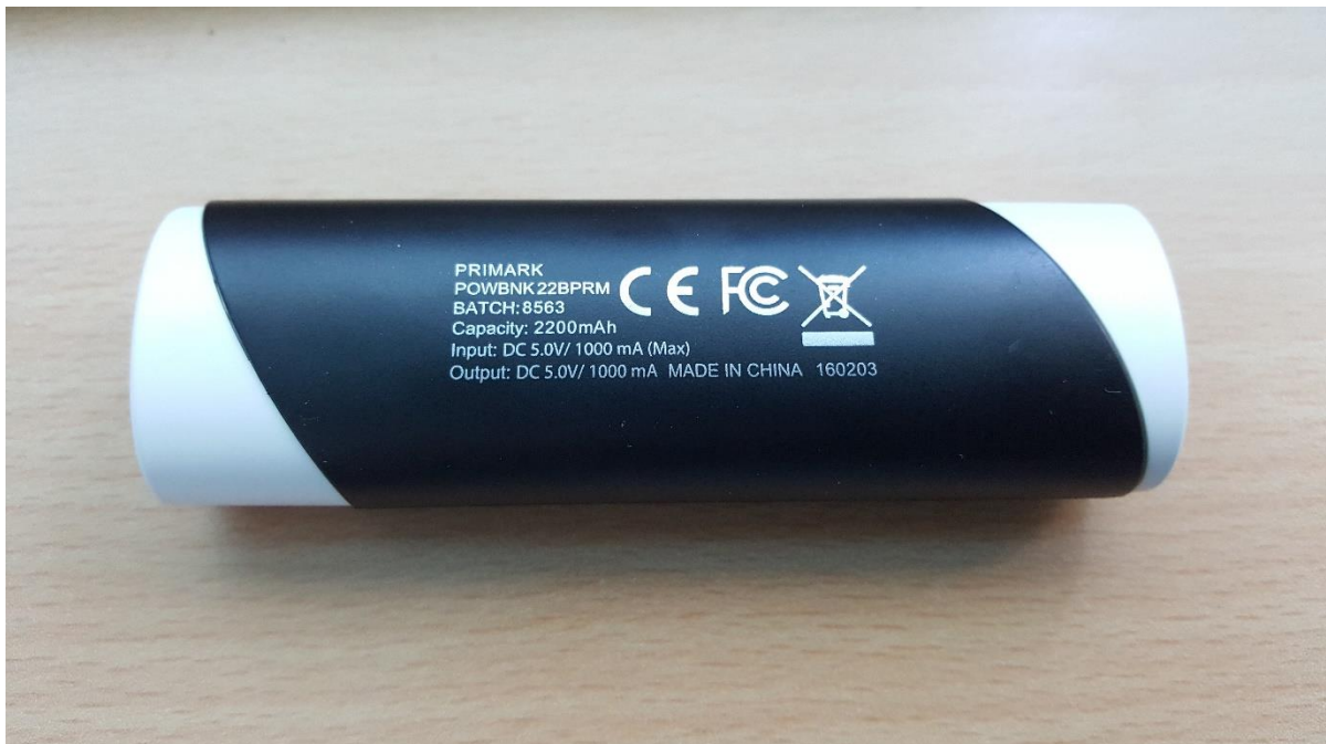
Figura 23. Características batería externa
