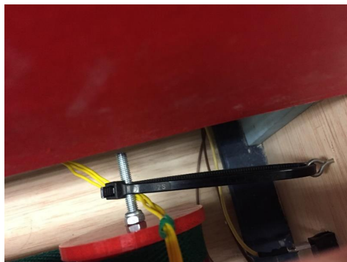
Ilustración 116. Uso de las bridas como tensores
