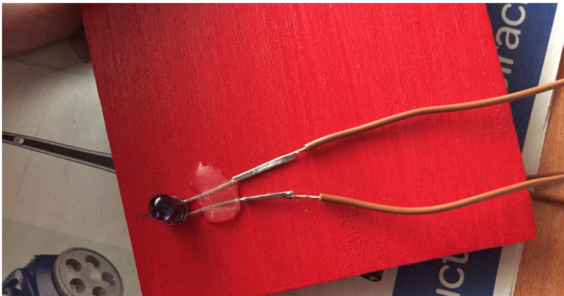
Ilustración 95. Colocación de uno de los leds
