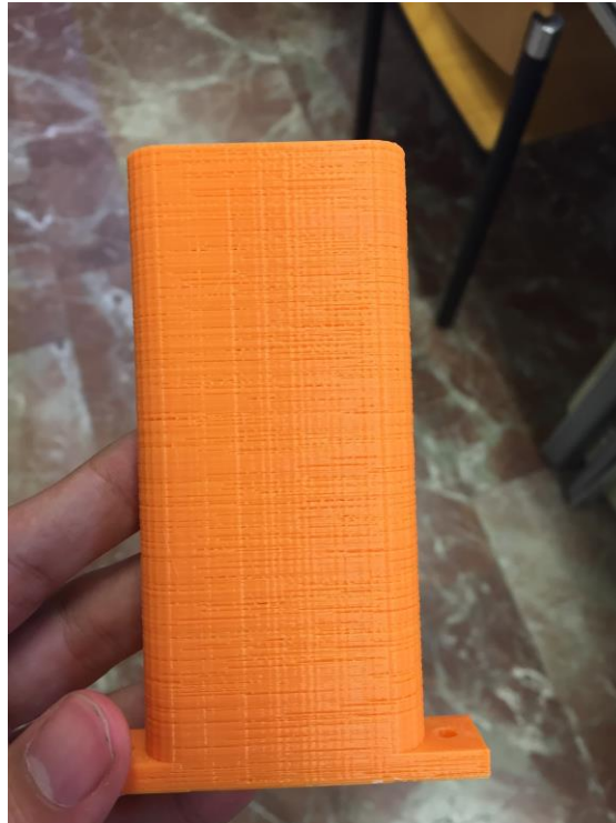
Ilustración 83. Pieza con fallos en el extrusor
