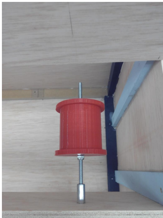
Ilustración 105. Polea esclava colocada en la estructura
