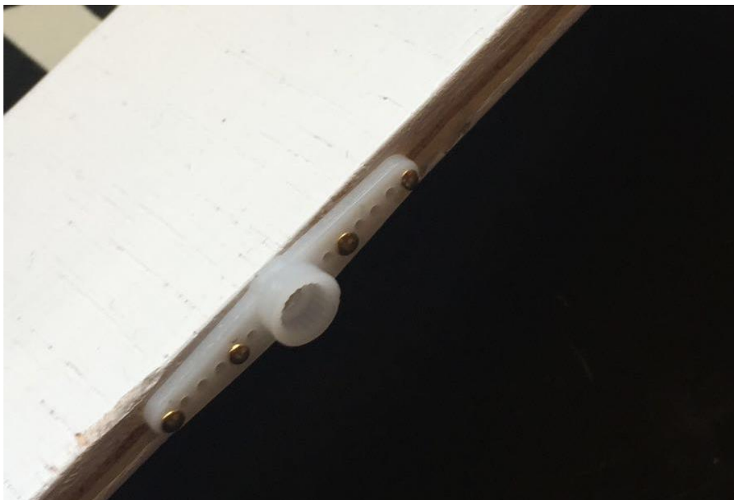
Ilustración 96. Fijación de palas a engranaje del servomotor
