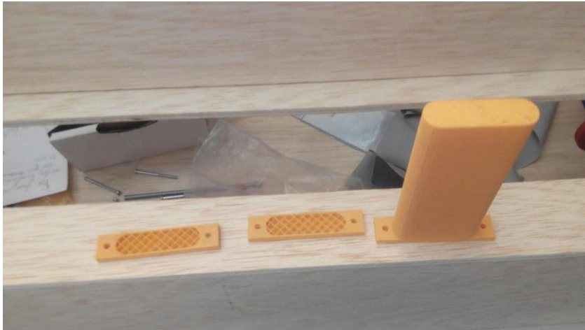
Ilustración 82. Pieza completa a la izquierda y otras dos que se quedaron a medias
