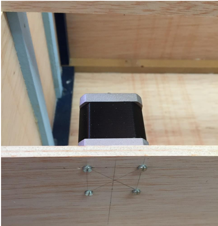
Ilustración 102. Colocación de un motor paso a paso
