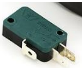
Ilustración 19. Microswitch interno del botón
