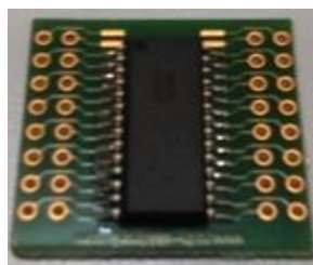
Figura 65. ISD1916 soldado sobre la PCB auxiliar
