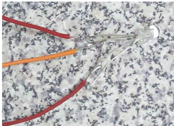
Figura 56. LED RGB con cables soldados a sus patillas
