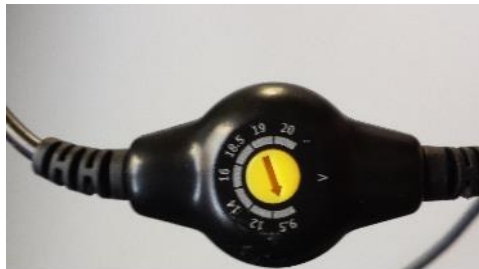
Figura 31. Selector de tensión entregada que incluye nuestro adaptador
