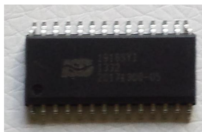
Figura 25. ISD1916 con encapsulado SOIC(28)
