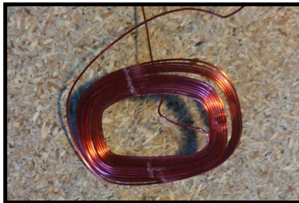
Figura 5.5 - Segundo intento de fabricación de la bobina receptora
