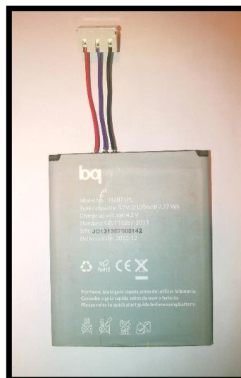
Figura 3.5 - Batería utilizada en el módulo receptor de carga
