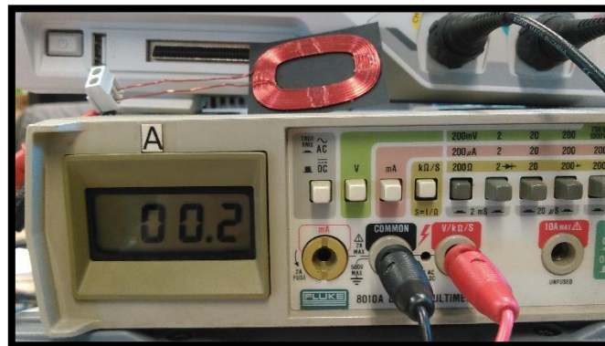
Figura 5.9 - Medida del valor de la resistencia en c.c. de la bobina
