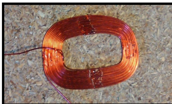
Figura 5.6 - Tercer intento de fabricación de la bobina receptora
