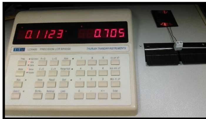
Figura 5.12 - Medición de la resistencia en c.c. de la bobina receptora
