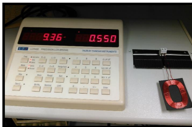
Figura 5.10 - Medición de la inductancia L_s de la bobina receptora
