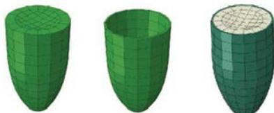
Figura 7. Detalle de la malla para la bala FMJ de 9 mm. De izquierda a derecha: núcleo, camisa y bala completa.
