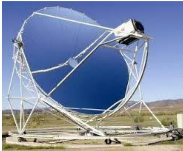
*Figura 2.2 Disco parabólico con motor de Stirling.*
