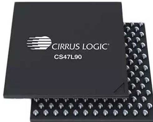
Ilustración 6. DSP CS47L90 de Cirrus Logic
