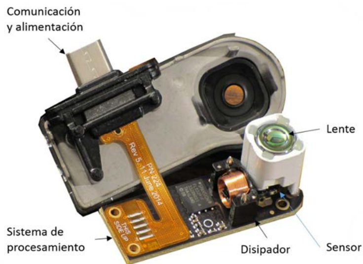
Figura 9.1. Componentes de las cámaras térmicas.
