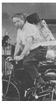
Figura 2.14 Norman J. Holter - 1947 - Prototipo del transmisor de ECG (Contrafatto s.f.).
