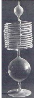
Figura 2.3 Termómetro en espiral, construido en 1657 por un soplador de vidrio florentino (Barros y Bravo 2001).
