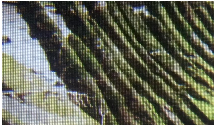
Figura 27: Efecto backdoor de la pantalla del Oculus Rift DK1.
