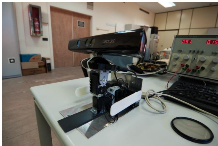
Figura 32: Estructura de servos Dynamixel con Kinect montada.
