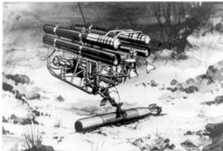
Figura 17: Ilustración de submarino CURV-I recuperando un torpedeo del lecho marino.
