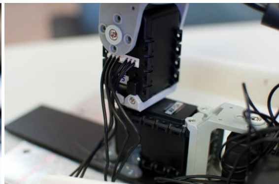
Figura 36: Montaje de los servos Dynamixel utilizados.
