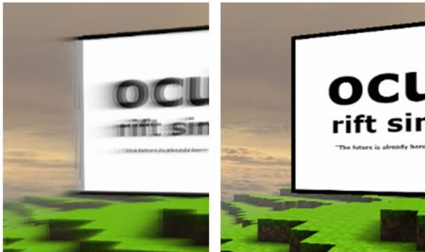
Figura 29: Izquierda - Pantalla del DK1. Derecha - Pantalla de baja persistencia del DK2.
