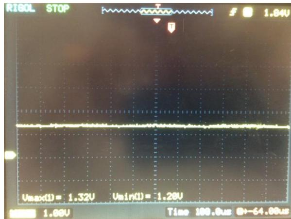
Fig. 55. Salida del comparador cuando se detecta el foco azul
