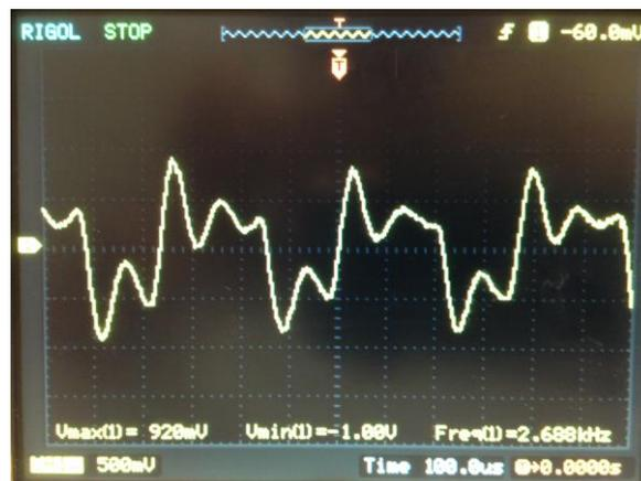
Fig. 41. Salida del convertidor corriente tensión (2.6 kHz)
