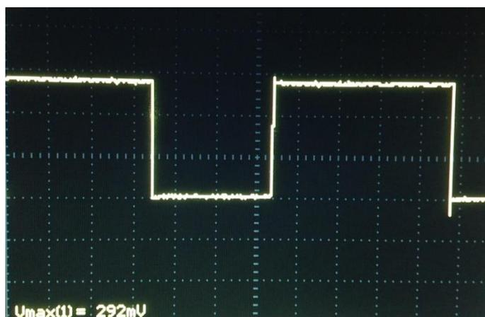
Fig. 30. Tensión en la resistencia de senseo con 5.5 V de alimentación
