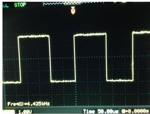
Fig. 67. Salida del 555 en modo monoestable 4.5 kHz
