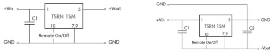
Fig. 79. Conexiones del TSRN 1-2450 para obtener una tensión positiva (imagen izquierda) o negativa (imagen derecha)
