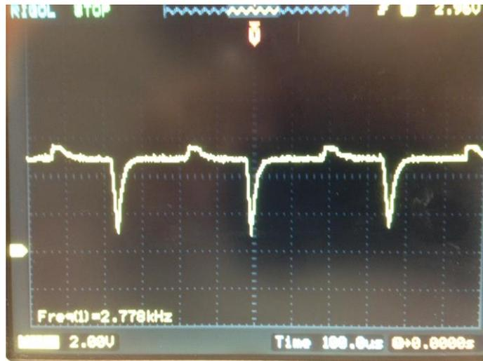
Fig. 63. Salida del derivador + diodo (2.6 kHz)
