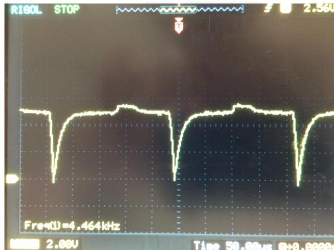
Fig. 64. Salida del derivador + diodo (4.6 kHz)
