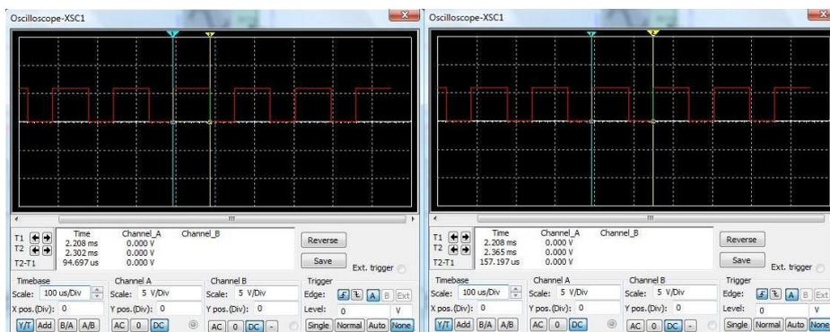
Fig. 23. Salida del 555 en modo astable con  $C_1 = 47$  nF (simulación)
