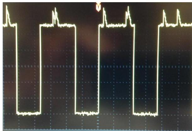
Fig. 34. Picos de tensión en la salida del 555
