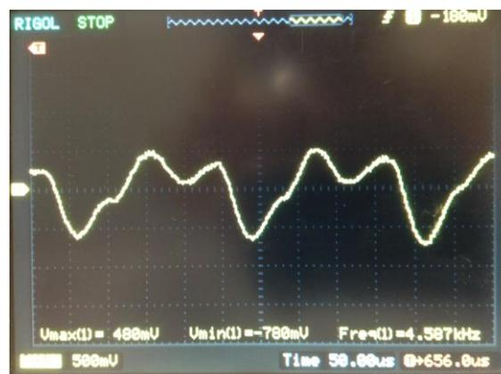
Fig. 42. Salida del convertidor corriente tensión (4.5 kHz)
