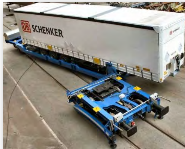
Figura 5.11. Maniobra de carga de un remolque en el vagón Megaswing .
