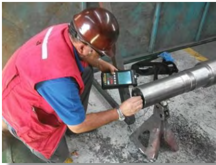
Figura 6.33. Inspección por ultrasonidos de un eje.
