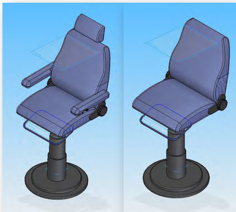
Figura 6.81. Asientos regulables en altura para el maquinista y el ayudante.
