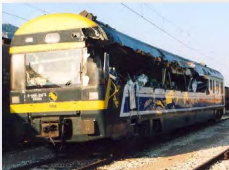
Figura 5.9. Estado del coche afectado por el impacto de la viga.
