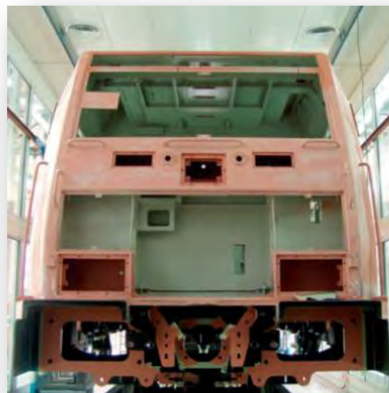
Figura 6.104. Testero en construcción.
