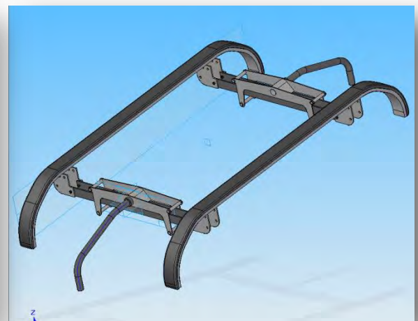
Figura 6.76. Cabezal de captación.
