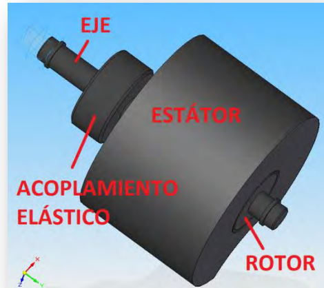
Figura 6.47. Vista del motor eléctrico, del acoplamiento elástico y del eje motriz.
