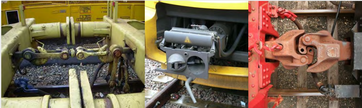
Figura 6.64. De izda. a dcha.: enganche de husillo, Scharfenberg y Janney.
