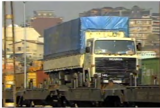
Figura 5.8. Momento de la carga de los semirremolques a través de las plataformas.
