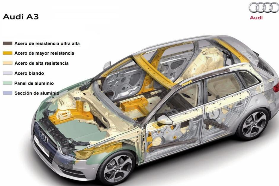
**Figura 26 - Uso de distintos aceros en la estructura de un Audi A3 (modificado de Audi)**
