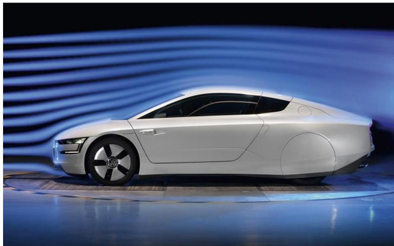
**Figura 30 - Volkswagen XL1 en el túnel del viento (Volkswagen)**
