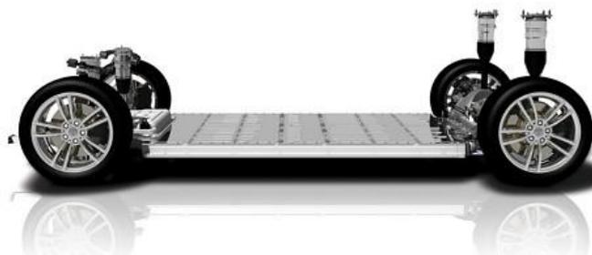
**Figura 62 - Suelo plano de un Tesla Model S [Tesla Motors]**
