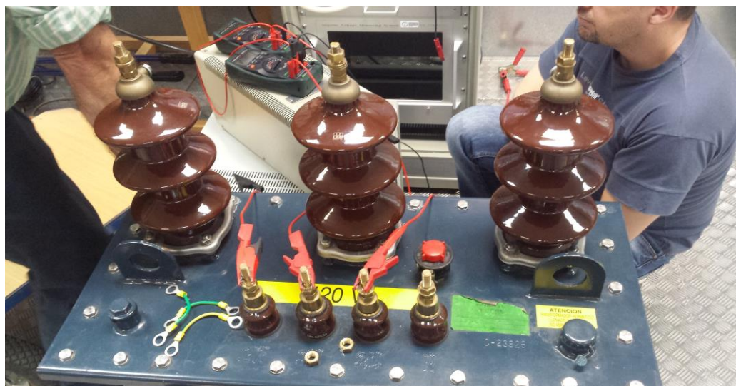
Figura 8.2: Conexión del ensayo de vacío en el Lab. De Alta Tensión [Foto propia].
