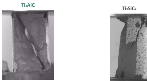
Figura 7.16 Muestras después de romper por carga a compresión de Ti_2AlC y Ti_3SiC_2 elaboradas sin espaciador.
