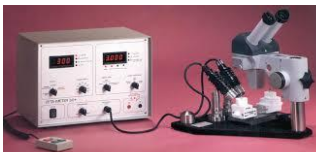
Figura 3. 8 Equipo utilizado para la medida del potencial Z, Zeta-Meter 3.0 + de ZETA METER Inc.
