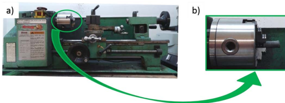
Figura 3. 21 a) Torno utilizado para mecanizar las muestras antes de ser ensayadas por RUS y b) cabezal de agarre de la probeta que va a ser mecanizada.
