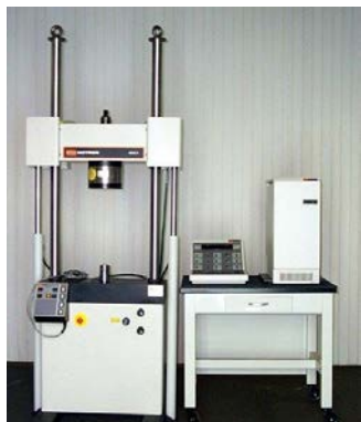
Figura 3. 22 a) máquina de ensayos mecánicos servohidráulica Instron 8501; b) derecha sistema de rótula empleado en el pistón inferior.
