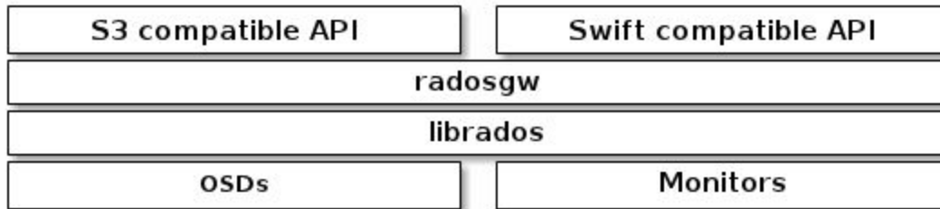
Figura A1.7: Diagrama de radosgw . La puerta de entrada de objetos se puede comunicar con cualquier API compatible con S3 o Swift y hace de intermediario con LIBRADOS. 15 (Inktank Storage Inc. 2015, Ceph Object Gateway)
