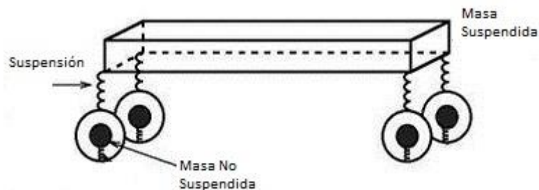
Figura 3.2 - Masas suspendida y no suspendida
