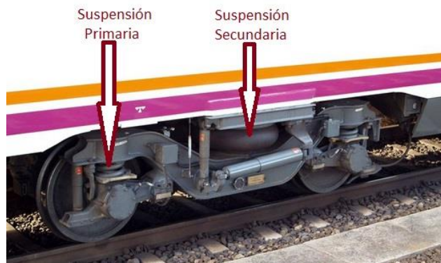
Figura 3.11 - Ejemplo de suspensión primaria y secundaria en un bogie
