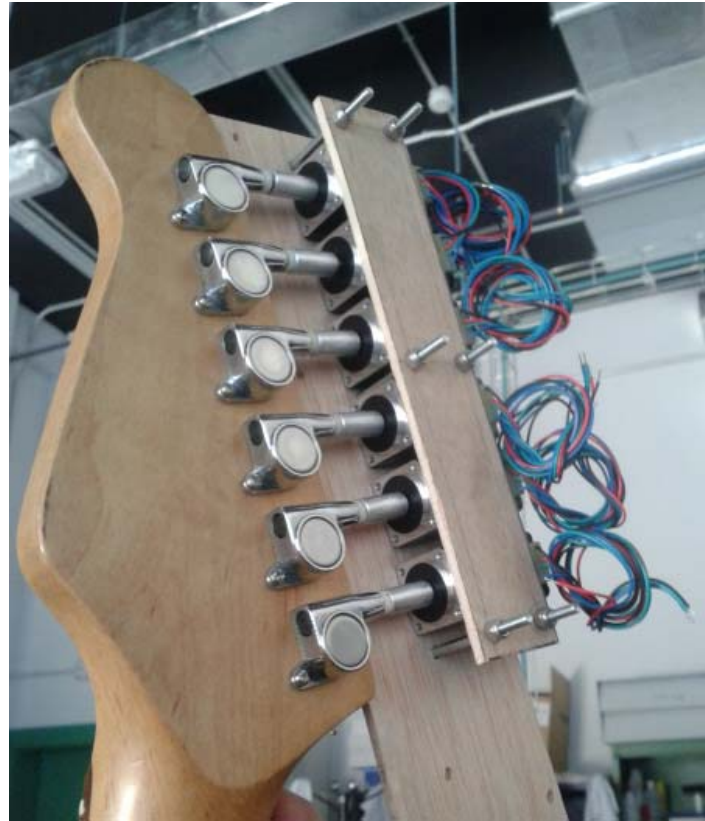
Figura 4.12 Primera etapa de montaje y prueba de las piezas “unión ejes”
