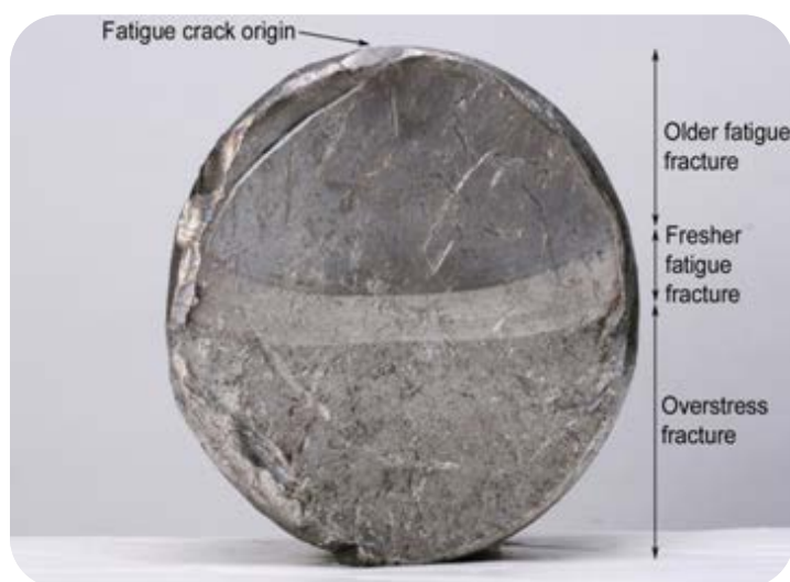
Ilustración 9. Sección de fallo por mecanismo de fatiga
