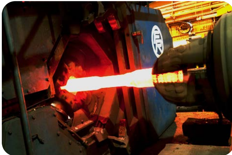
Ilustración 3. Conformado de eje
