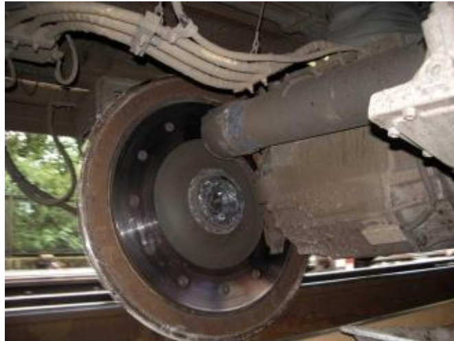
Figura 10. Eje motor fracturado del tren ICE 3 que descarriló en Colonia [6]
