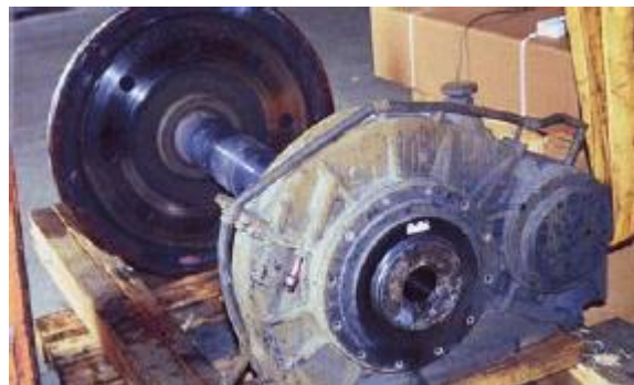
Figura 9. Eje motor fracturado del tren Clase 73 que descarriló en Noruega
