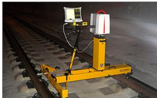
Figura 41. Equipo laser de medición de gálibos.
