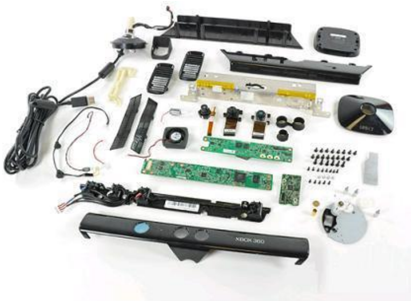
Figura 15: Despiece de la cámara Kinect.
