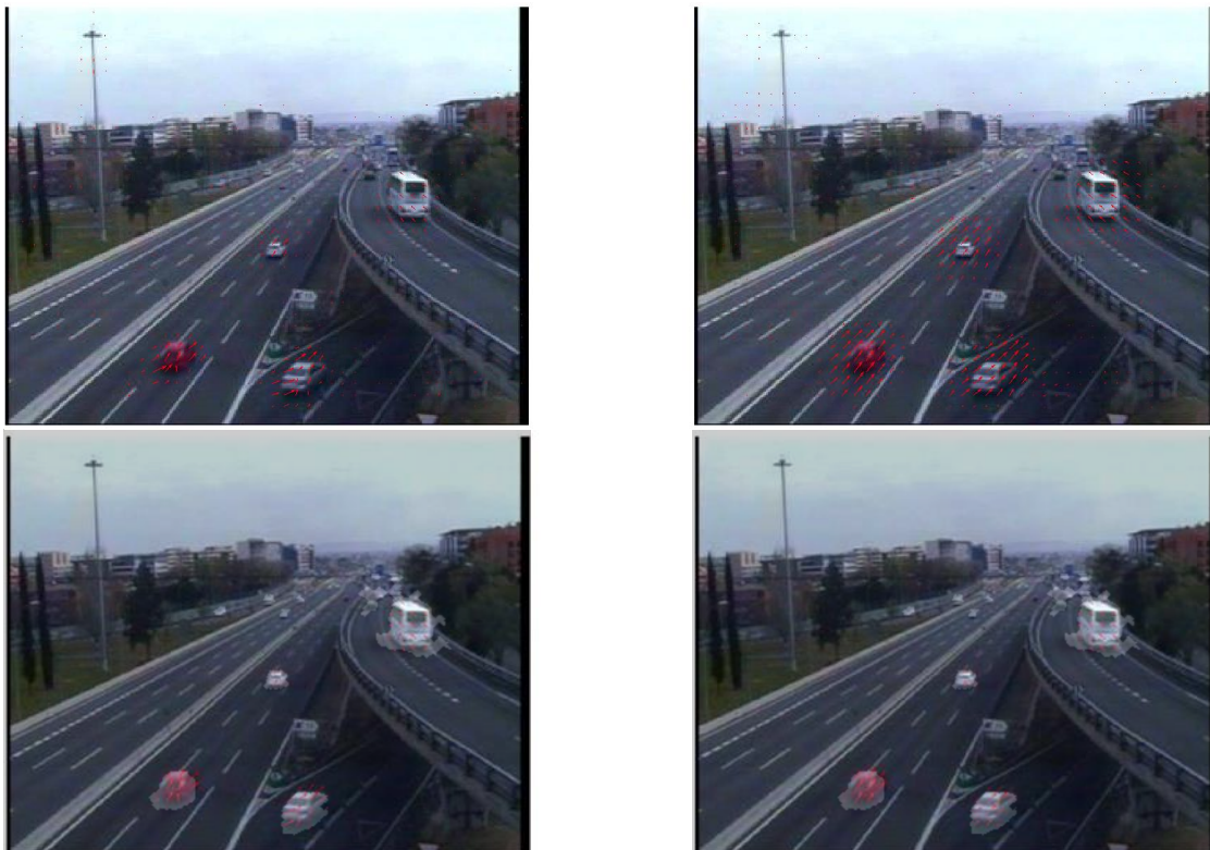
Fig. 3.6: vectores resultantes de la estimación de movimiento con el algoritmo L&K. Izquierda, r=5 . Derecha, r=15 . Arriba, sin aplicar máscara de foreground. Abajo, aplicando máscara de foreground.
