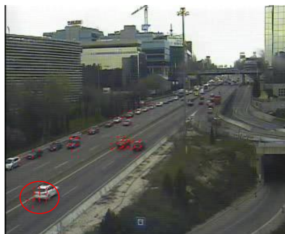
Fig. 3.20: vectores de movimiento ruidosos en la parte posterior del vehículo
