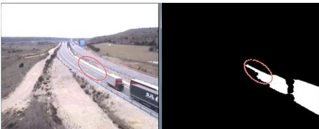
Fig. 4.10: rastro de máscara de foreground ocasionada por el paso de vehículos
