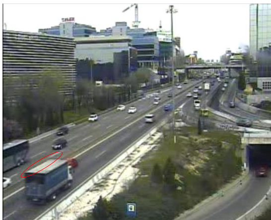
Fig. 3.19: vehículo cuya parte superior obstruye el carril contrario
