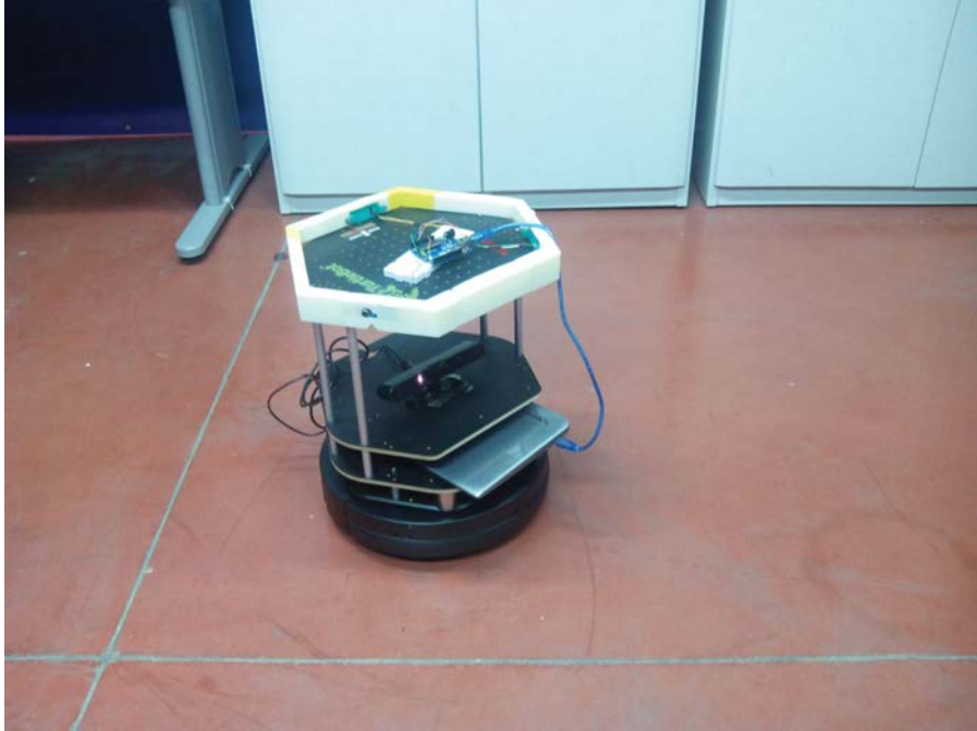
Figura 6.19: Turtlebot equipado con micrófonos y el sensor RGB-D de Asus.
