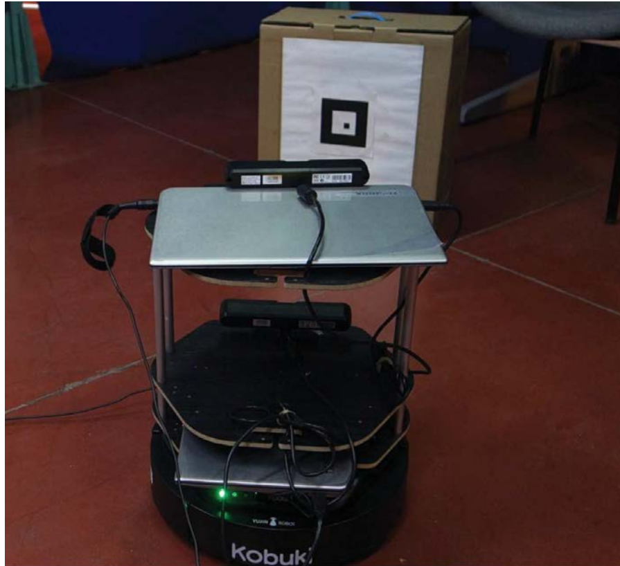
Figura 6.36: Se introduce en el campo visual del robot una caja con una etiqueta que corresponde al objeto ordenador . El robot interpreta que está percibiendo un ordenador.
