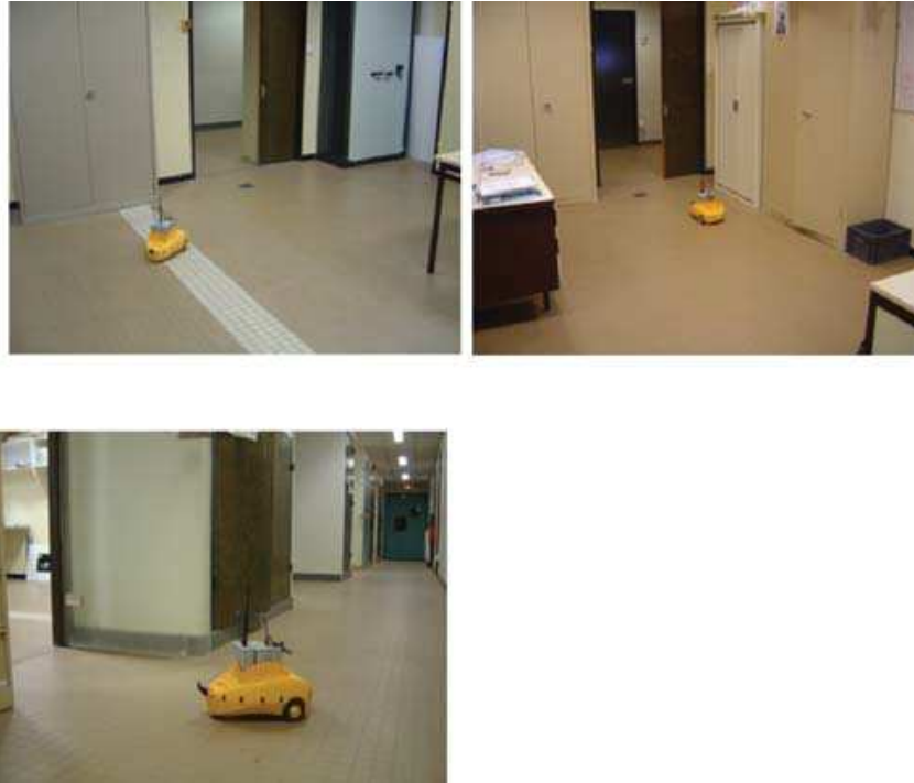
Figura 2.9: Construcción de la memoria visual: En las estancias (a) y (b) y el pasillo (c), el camino r\Psi_p fue aprendido teleoperando el robot.
