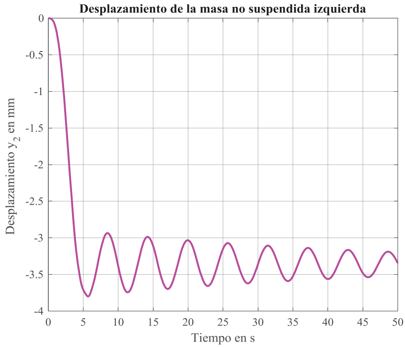
Figura 7-8 Desplazamiento de la masa no suspendida izquierda frontal vs. tiempo.
