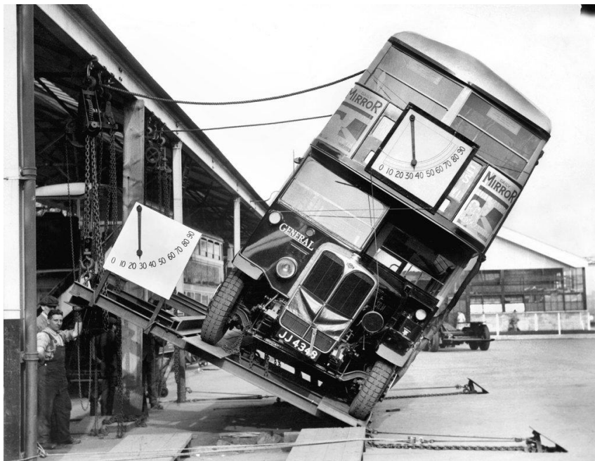
Figura 2-1 Pruebas de inclinación de autobuses: foto histórica de una prueba con el famoso autobús urbano de Londres.
