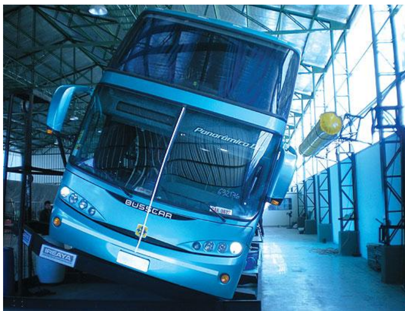
Figura 2-2 Pruebas de inclinación de autobuses: ensayo a un bus moderno.
