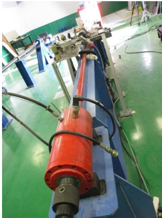
Figura 3.1. Cañón de gas utilizado en los ensayos de impacto.
