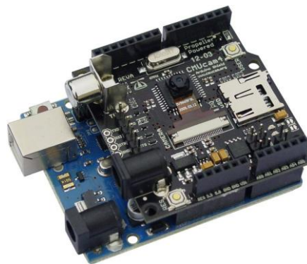
Figura 8. Ejemplo de expansión de una tarjeta Arduino UNO mediante un escudo.
